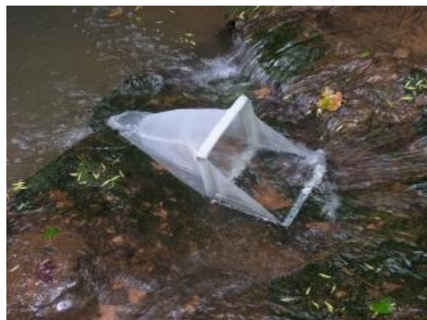
Filet surber placé face au courant pour réaliser un prélèvement
