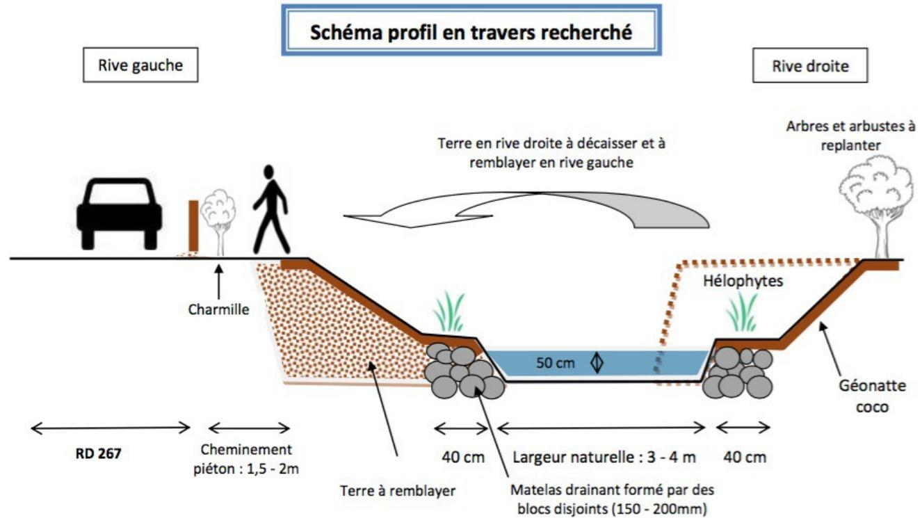
Risque inondation : objectif de conservation de la section hydraulique pour ne pas aggraver le risque d'inondation
